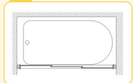
Detalle de la guía inferior con las puertas en posición correcta.
